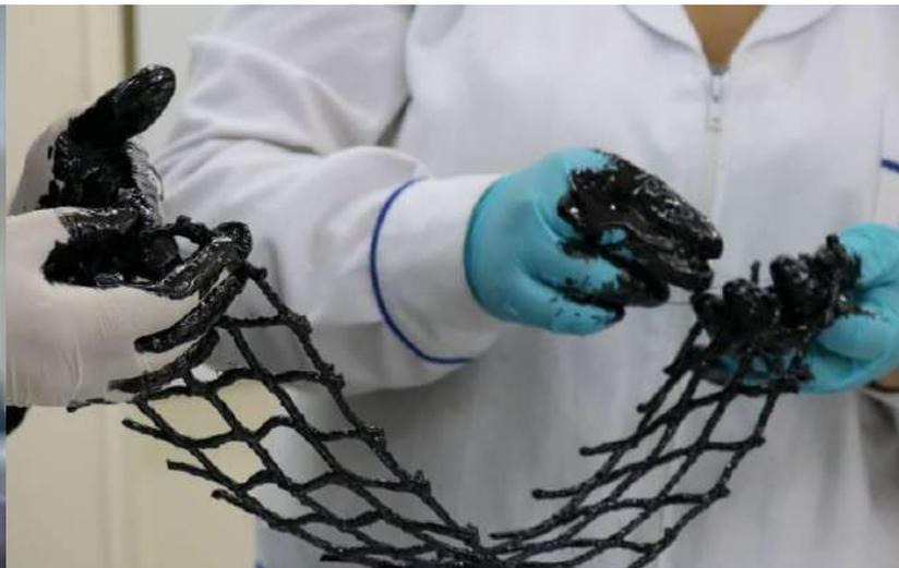
Un aspecto destacado de esta pintura y recubrimiento nanoestructurado es que carecen de metales y biocidas, ya que actúan físicamente para inhibir la formación de biopelículas precursoras del fouling.
